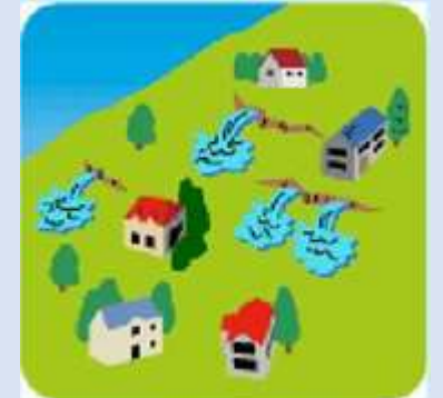
斜面から水が噴き出す
